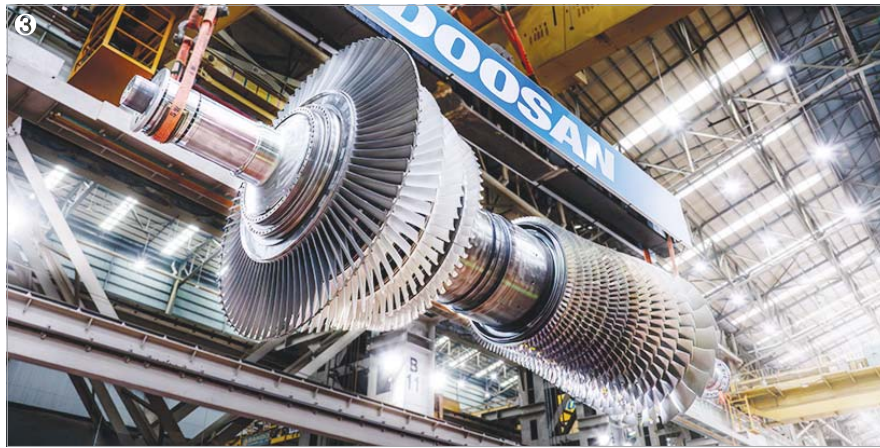
① 지난 2월 11일 박정원 두산그룹 회장(왼쪽)이 경남 창원 두산에너지빌리티 사업장을 방문해 제작 중인 발전용 가스터빈 제품을 살펴보고 있다. ② 지난 10월 6일 두산에너지빌리티 창원 본사에서 개최된 380MW 가스터빈 출하식에서 스페이스XAI 주요 관계자들과 손승우 파워서비스BG장(사진 가운데)을 비롯한 두산에너지빌리티 임직원들이 기념 촬영하고 있다. ③ 두산에너지빌리티가 개발하고 제작한 380MW급 가스터빈 제품. /두산그룹
