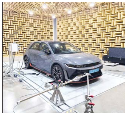
한국자동차연구원 고성능 전동화센터에 구축한 전기차 전용 무향실 차대동력계 장비 /한자연
