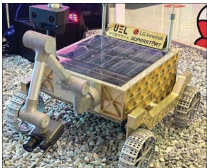
LG 카메라 모듈, 배터리 셀, 통신 모듈용 안테나가 탑재된 무인탐사연구소의 달 탐사 로버. /LG
