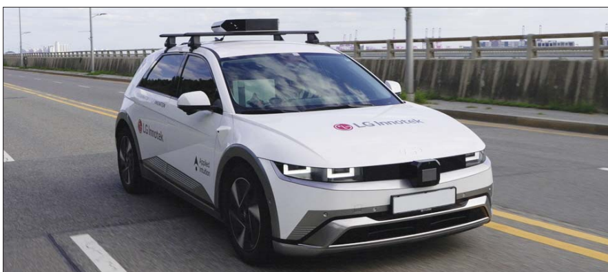
LG이노텍의 자율주행 센싱 데이터 수집 차량(Data Collection Vehicle)이 도심을 달리고 있다.
