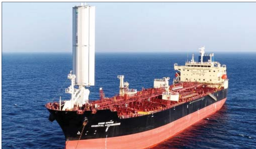
'윙세일(Wing Sail)'을 설치한 HMM의 5만톤급 중형 유조선(MR탱커) '오리엔탈 아쿠아마린(Oriental Aquamarine)'호.
