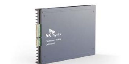
SK하이닉스의 컴퓨터익스프레스링크(CXL) 2.0 기반 D램 솔루션 CMM(CXL 메모리 모듈)-DDR5 96GB 제품. /SK하이닉스
