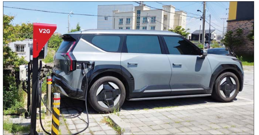
현대차그룹의 제주도 V2G 실증 시범서비스 참여 고객의 제주도 눈세길 소재 자택에 설치된 양방향 충전기를 기아 EV900이 이용하는 모습.
