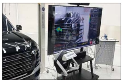
소음이 발생한 위치가 모니터에 초록색으로 표시되며 이를 통해 차량의 문제점을 분석하는 정비. /양성운 기자
