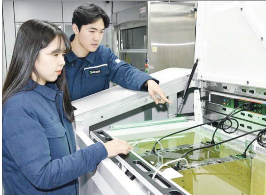
HD현대오일뱅크 직원들이 액침냉각설비에 담긴 냉각유와 서버를 테스트하고 있다. /HD현대오일뱅크
