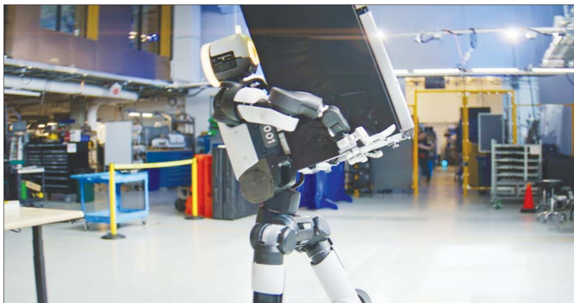
보스턴다이나믹스가 지난달 18일(현지 시간) 자사 유튜브 채널에 휴머노이드 로봇 아틀라스가 냉장고를 통째로 전달하는 영상을 공개했다. 영상에서 아틀라스는 23kg에 달하는 무거운 소형 냉장고를 무릎을 반쯤 굽힌 뒤 양팔을 사용해 균형을 유지하며 뒤쪽에 위치한 테이블까지 이동, 상체만 180도로 회전해 테이블 위에 내려놓았다. /보스턴다이나믹스 유튜브 영상 캡처
