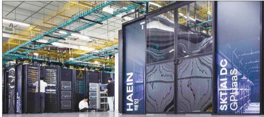
SK브로드밴드 가산 AI DC에 구축된 B200 클러스터 '해인'의 내부 모습. SK텔레콤은 가산 AI DC에 H100에 이은 최신 B200 GPU 클러스터를 조성했다. /SKT
