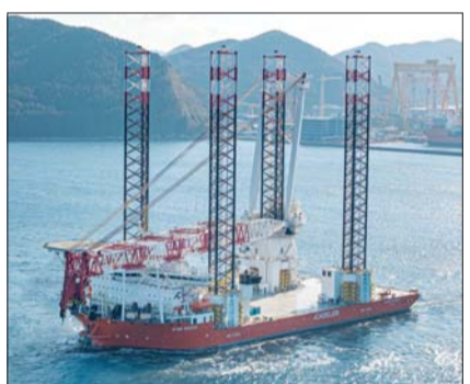
한화오션이 건조한 대형 해상풍력발전기 설치선(WTIV) 시운전 모습. /한화오션
