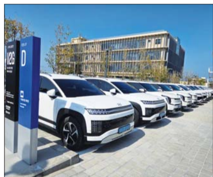
현대차그룹의 제주도 V2G 실증 서비스 현장에서 전기차들이 양방향 충전기에 연결돼 실제 충·방전을 통해 전력을 주고 받고 있다.
