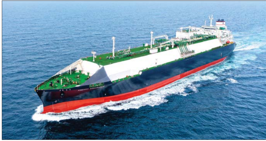
HD현대삼호에서 건조해 지난 2024년 인도한 17만 4000 입방미터(m³)급 LNG운반선의 시운전 모습. /HD현대
