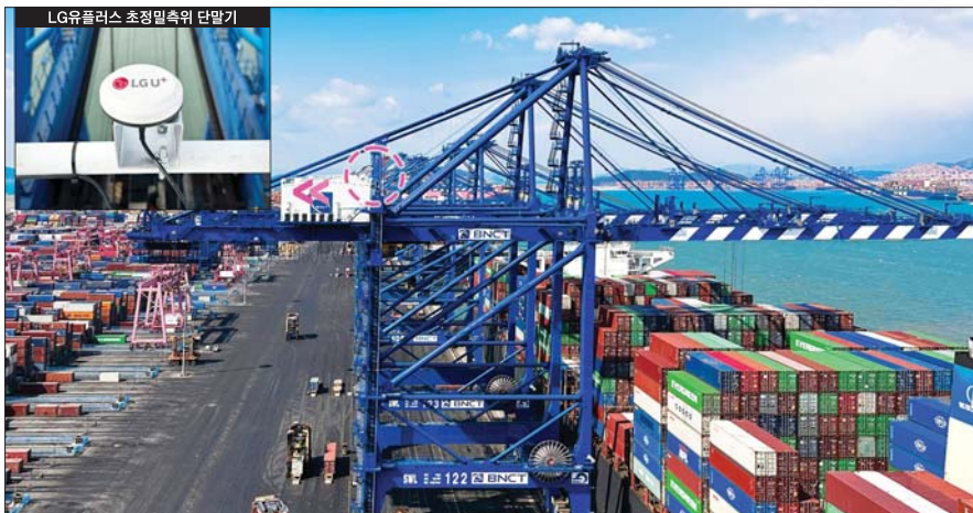
부산신항 5부두에 위치한 항만 크레인에 설치된 조정밀측위(RTK) 단말의 모습. /LG유플러스
