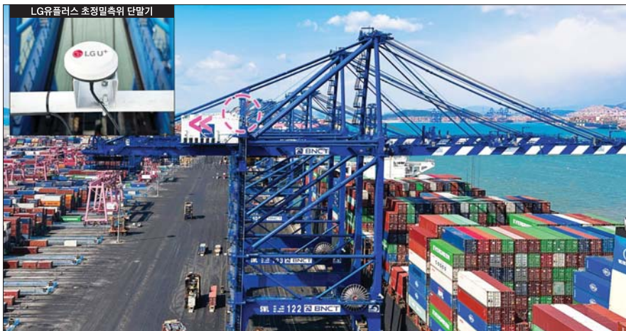
부산신항 5부두에 위치한 항만 크레인에 설치된 조정밀측위(RTK) 단말의 모습.
