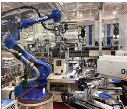
포스코모빌리티솔루션 포항공장 구동모터코어 스테이터(Stator) 생산라인에서 야스카와로봇이 생산된 제품을 품질검사 측정기로 이송하고 있다.
