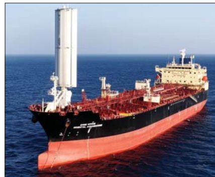
'윙세일(Wing Sail)'을 설치한 HMM의 5만톤급 중형 유조선(MR탱커) '오리엔탈아쿠아마린(Oriental Aquamarine)'호. /HMM
