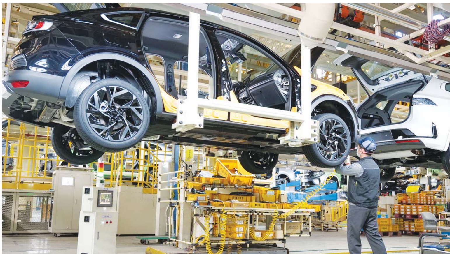
르노코리아 부산공장 조립공장 내 새롭게 설치한 전기차 생산 대응 새시행거.
