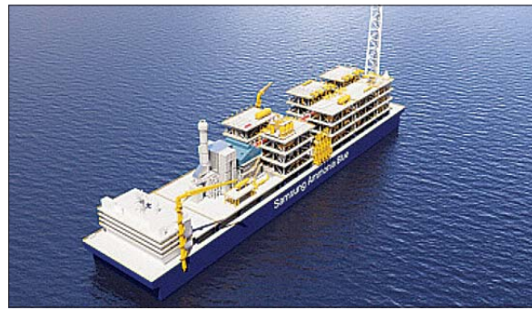
부유식 블루 암모니아 생산설비.
