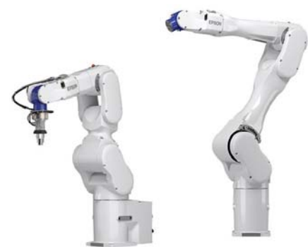
(왼쪽부터) 포스센서가 장착된 C8 (암 길이 900mm), C8/12 (암 길이 1400mm) 모델
