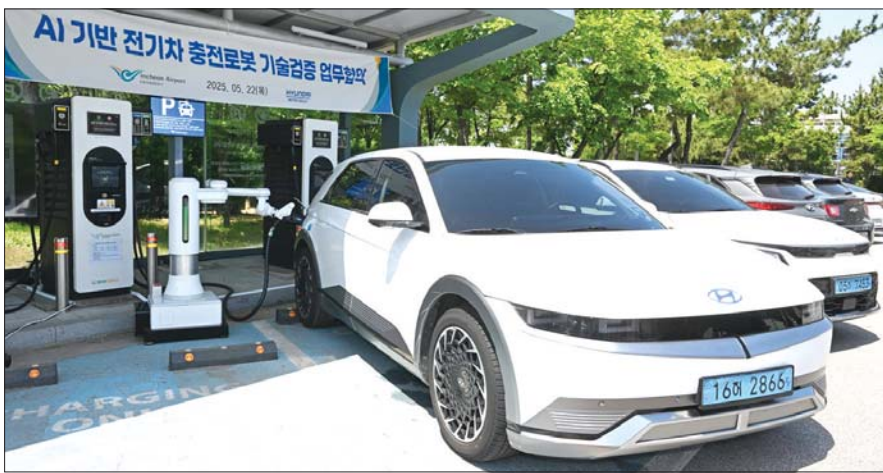
AI 기반 전기차 자동 충전 로봇으로 현대차 아이오닉5 차량을 충전하는 모습.
