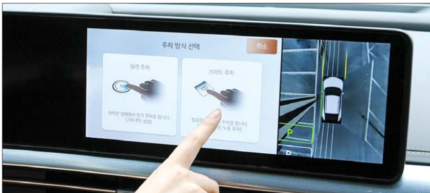
현대모비스가 개발한 차세대 주차제어시스템 시연 장면. 운전자 핸들 조작없이 학습된 경로를 따라 자동 주차하는 ‘메모리 주차 지원’, 주차선 인식 기능을 추가해 진일보한 자동 주차를 구현한 ‘원격 자동주차시스템 2’ 등 다양한 주차제어 기능을 지원한다.
