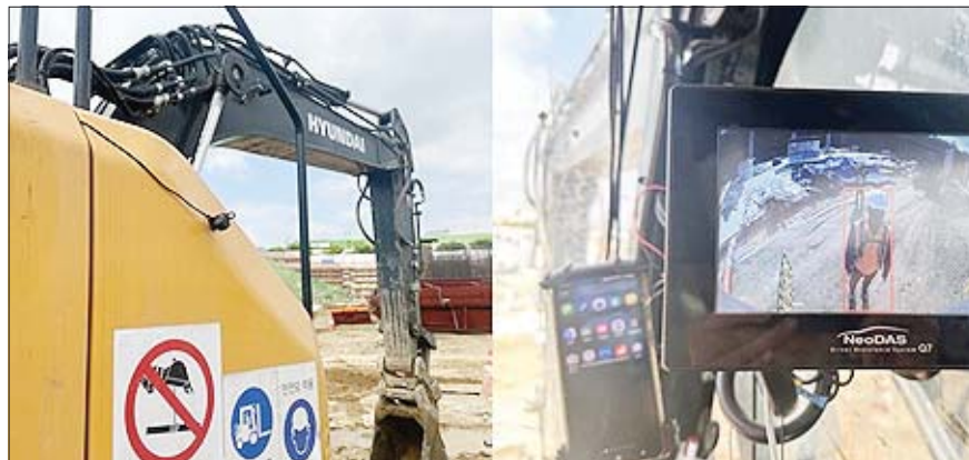
현장 굴착기에 부착된 측후방 카메라(왼쪽) 및 디스플레이 내 인체 인식 장면.
