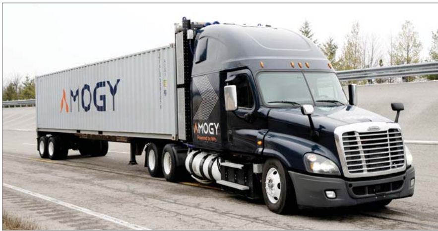
아모지가 암모니아 기반 수소 연료전지 시스템을 적용해 실증을 진행했던 대형트럭
