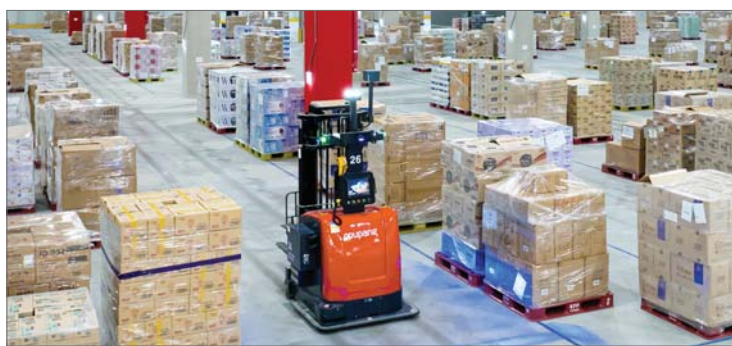
쿠팡 대구 풀필먼트 센터에 도입한 무인 지게차의 모습. 직원이 누르는 버튼 한 번으로 알아서 대용량 제품을 옮겨줘 직원의 안전도 보장한다. /쿠팡
