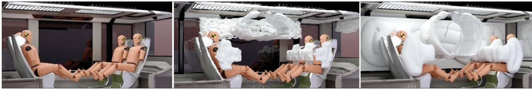
현대모비스의 PBV용 에어백들이 작동하는 모습. ① 차량 천정에서 ‘대면좌좌 에어백’이 내려와 마주보는 승객간 충돌을 방지하고, ② 천정과 지붕 연결부에서는 ‘커튼 에어백’이 실내 전체를 감싼다. ③ 동시에 좌석 시트에 장착된 ‘전방위 에어백’이 승객들의 몸을 보호하듯 둘러 상해를 최소화한다.
