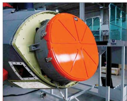
한화시스템이 한국형 전투기 KF-21에 장착한 AESA레이다.
