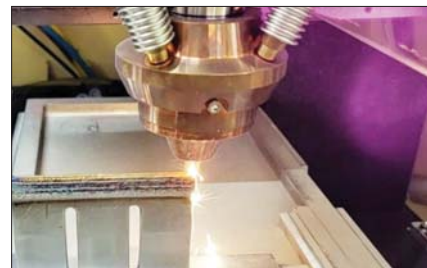
한국타이어앤테크놀로지와 한국원자력연구원이 개발한 금속 3D 프린터로 Ti 합금 블레이드의 손상부를 복원하고 있다.
